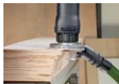
Фрезерование пластмассовой или деревянной кромки.
