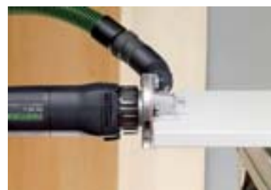
Скругление пластмассовой или деревянной кромки.
